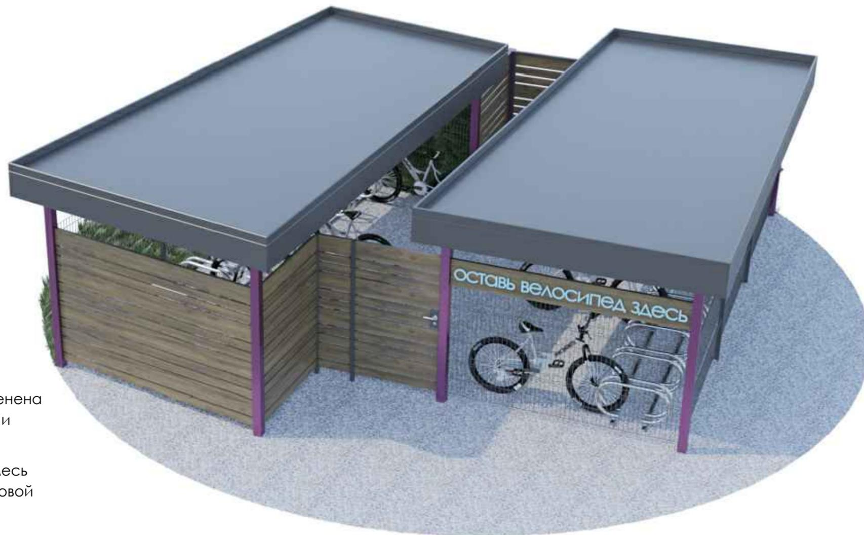
2 В качестве заполнения между опорными столбами применена комбинация из материалов: 3D сетка с полимерным покрытием и деревянная доска из лиственных пород дерева.
